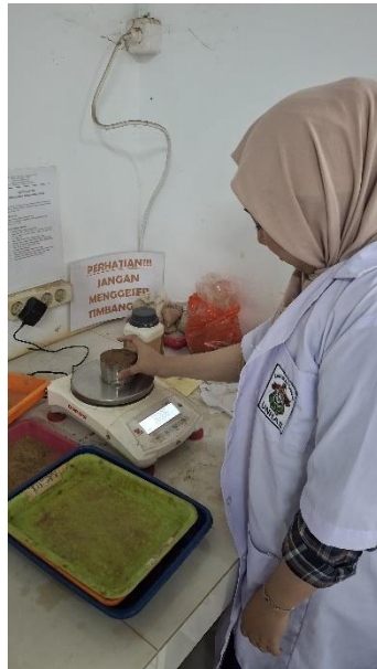
Gambar Lampiran 4. Pengukuran Bulk Density metode Gravimetry
