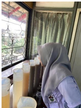
Gambar Lampiran 2. Pengukuran tekstur metode hidrometer
