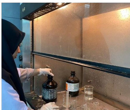
Gambar Lampiran 3. Pengukuran C-Organik dengan metode Walkey and Black
