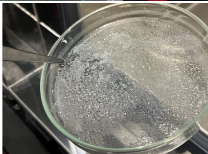
Gambar 3: Proses isolasi dan pembuatan silika dari diatom
