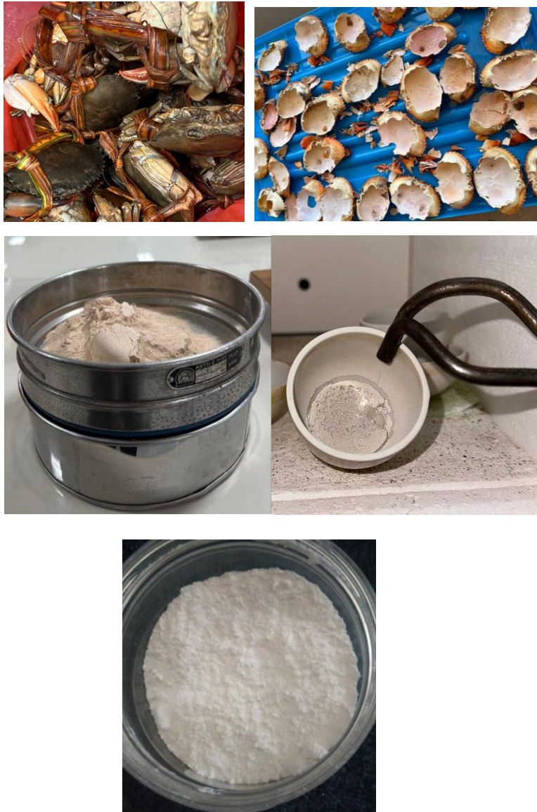
Gambar 1: Proses pembuatan serbuk cangkang kepiting bakau hingga menjadi Hidroksiapatit
