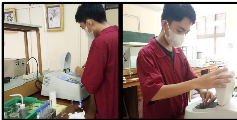
Tahapan Pengukuran Nilai Absorbansi Larutan Kurva Standar dan Kadar Amonia Kultur Jamur Menggunakan Spektrofotometer UV - Vis
