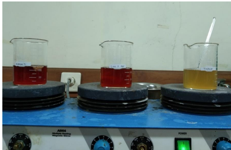
Penambahan \text{H}_2\text{SO}_4 30 % lalu volume sampel direduksi
