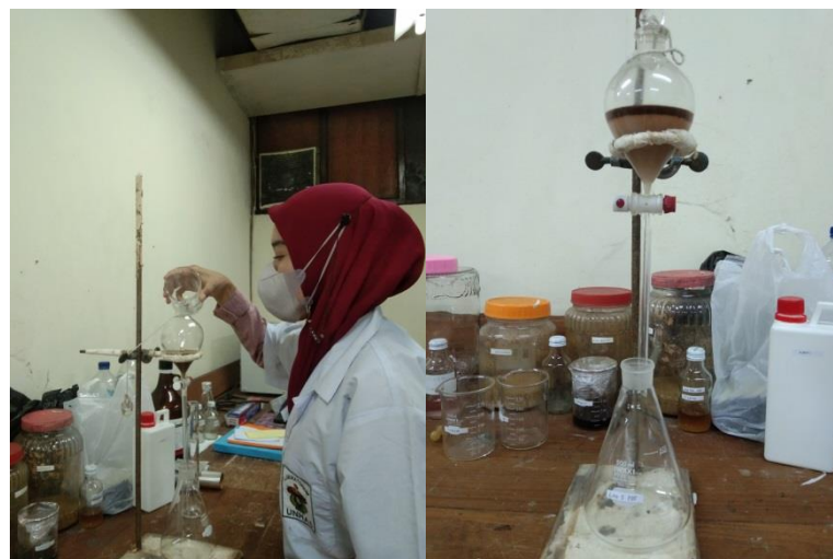
Penambahan \text{NaOH} 10 % dan kloroform pada corong pisah
