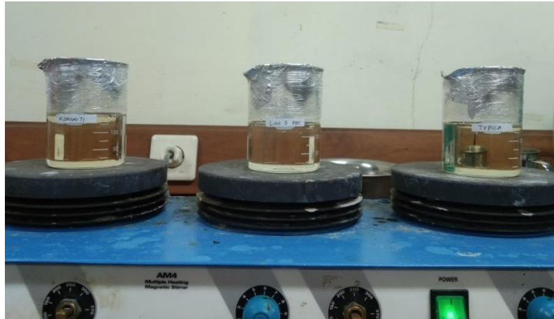
Fraksi kloroform diuapkan pada suhu 70-80 °C
