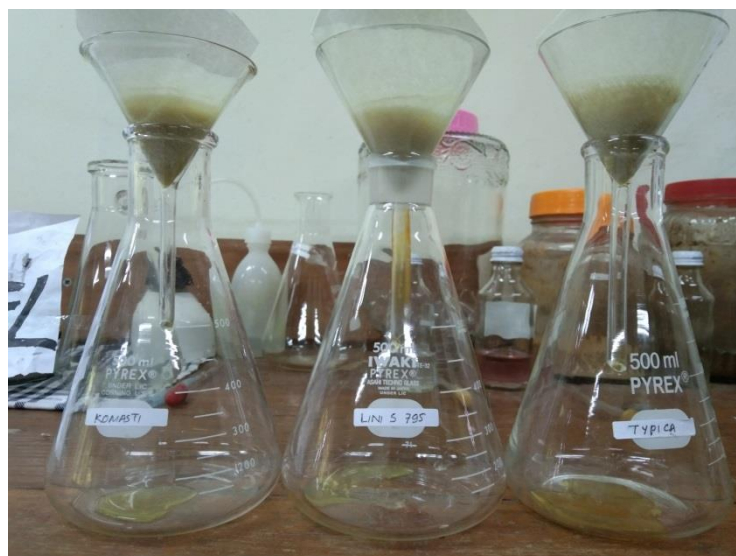
Penyaringan ekstrak sampel
