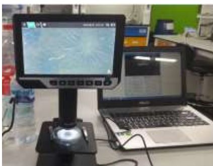
Proses identifikasi morfologi film dengan mikroskop optic digital
