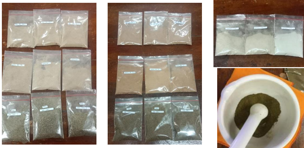
Gambar 12. Sampel setelah dihaluskan dan diayak
