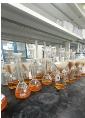
Penambahan demin dan Penyaringan
