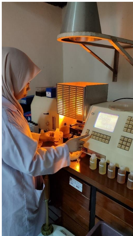
Gambar 19. Proses analisis sampel dengan menggunakan SSA
