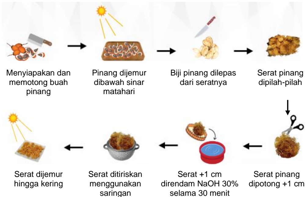
Gambar II.1 Ekstraksi Serat Buah Pinang
