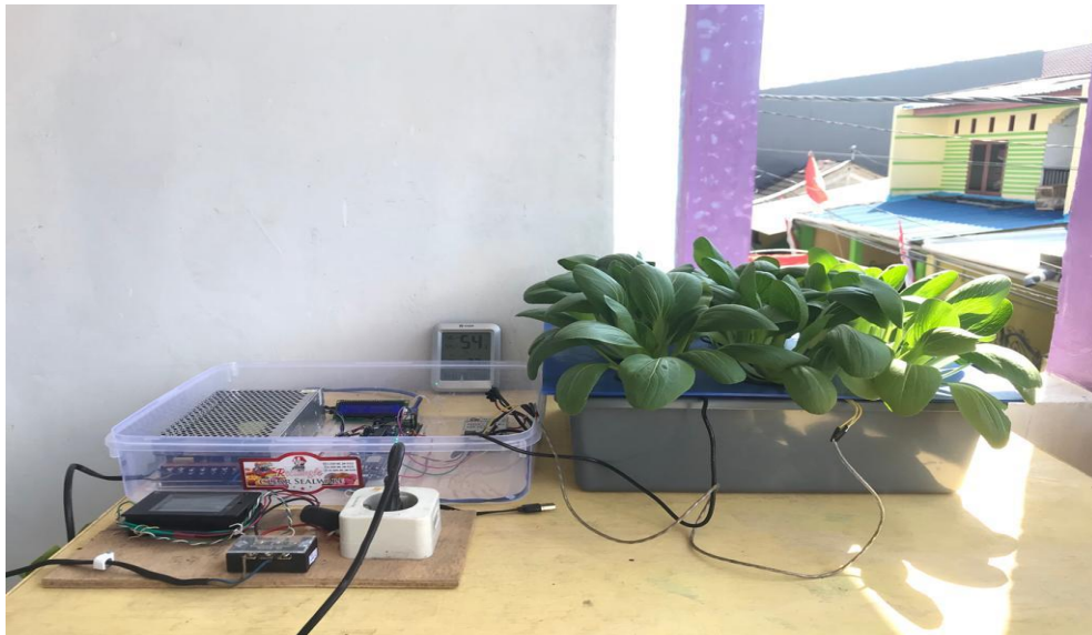
Gambar 2. Rangkaian sistem fogponic yang dilengkapi sistem kontrol
