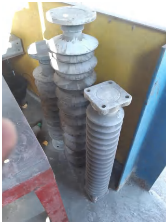
(Isolator Polimer dan Isolator Porselin Berpolutan)
