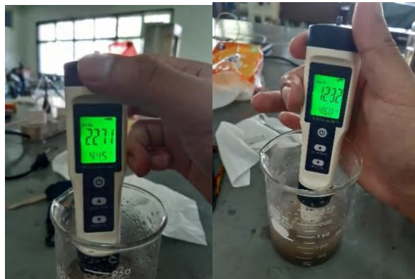
(Proses Pengukuran Konduktivitas Larutan Menggunakan Stirrer Isolator Polimer (Kanan) dan Isolator Porselin (Kiri))
