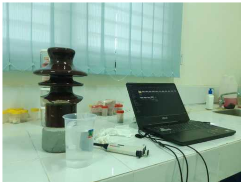
(Proses Percobaan Pengukuran Sudut Kontak Pada Isolator)
