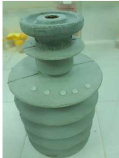
(5 Sampel Droplet air pada permukaan Isolator)
