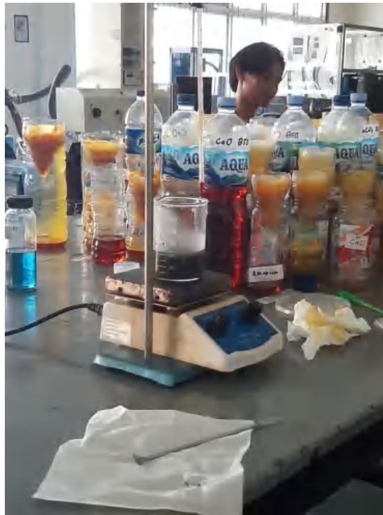
(Proses Pengadukan Larutan Polutan Semen Menggunakan Magnetic Stirrer Pada Lab. Internal Combustion Teknik Mesin)
