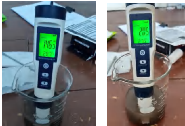
(Proses Pengukuran Konduktivitas Larutan Tanpa Menggunakan Alat Pengaduk Isolator Polimer (Kanan) dan Isolator Porselin (Kiri))
