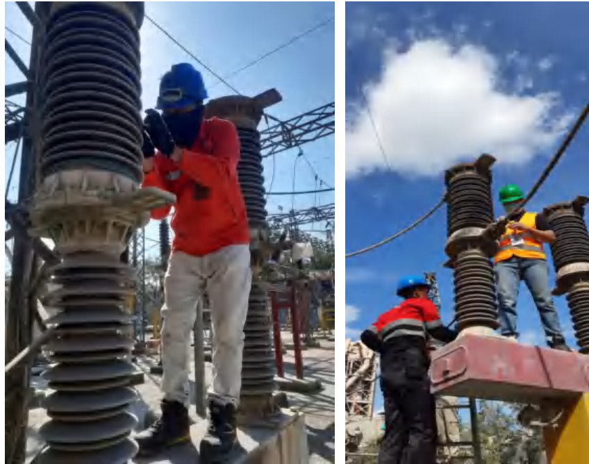
(Proses Pengumpulan Polutan Semen Pada Isolator)
