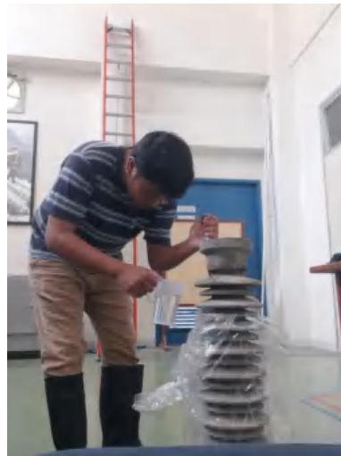
(Proses Penetesan droplet air pada isolator)
