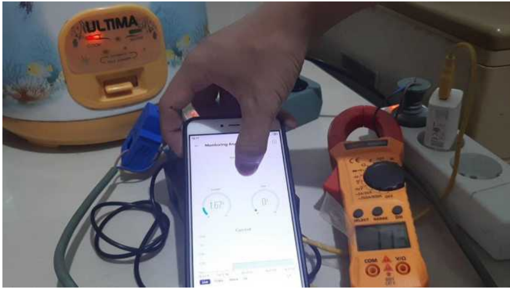
Lampiran 6 Pengujian sensor SCT-013 pada AC
