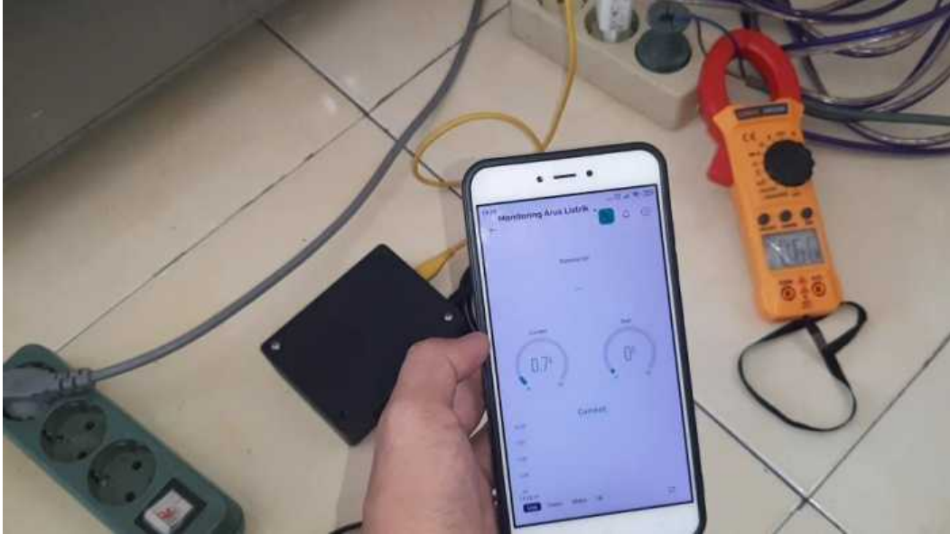
Lampiran 2 Pengujian sensor SCT-013 pada TV
