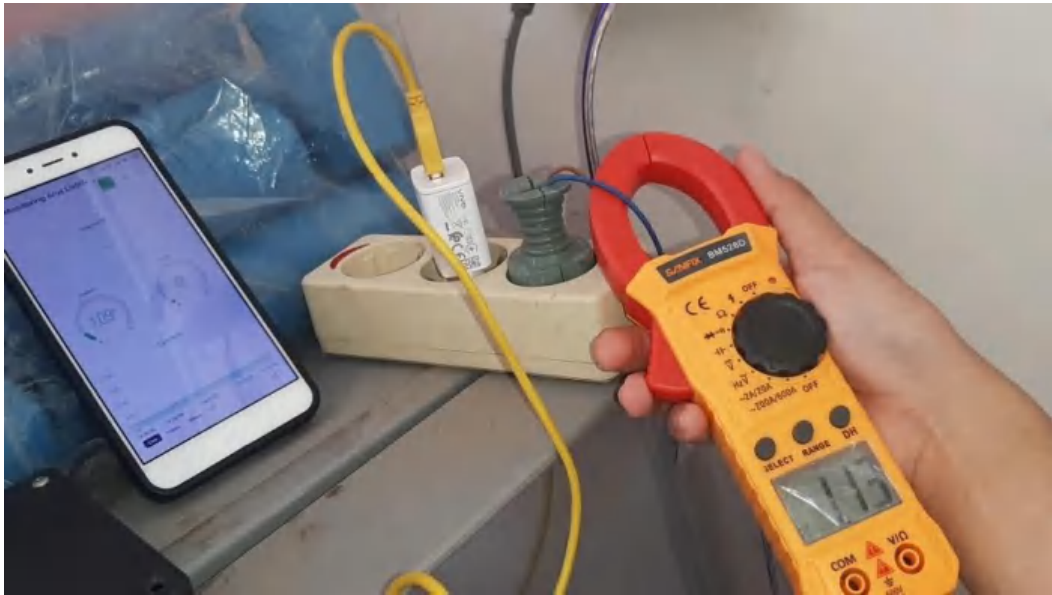
Lampiran 3 Pengujian sensor SCT-013 pada pompa air
