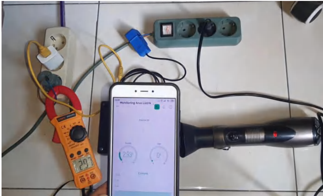
Lampiran 8 Pengujian sensor SCT-013 pada vacuum cleaner
