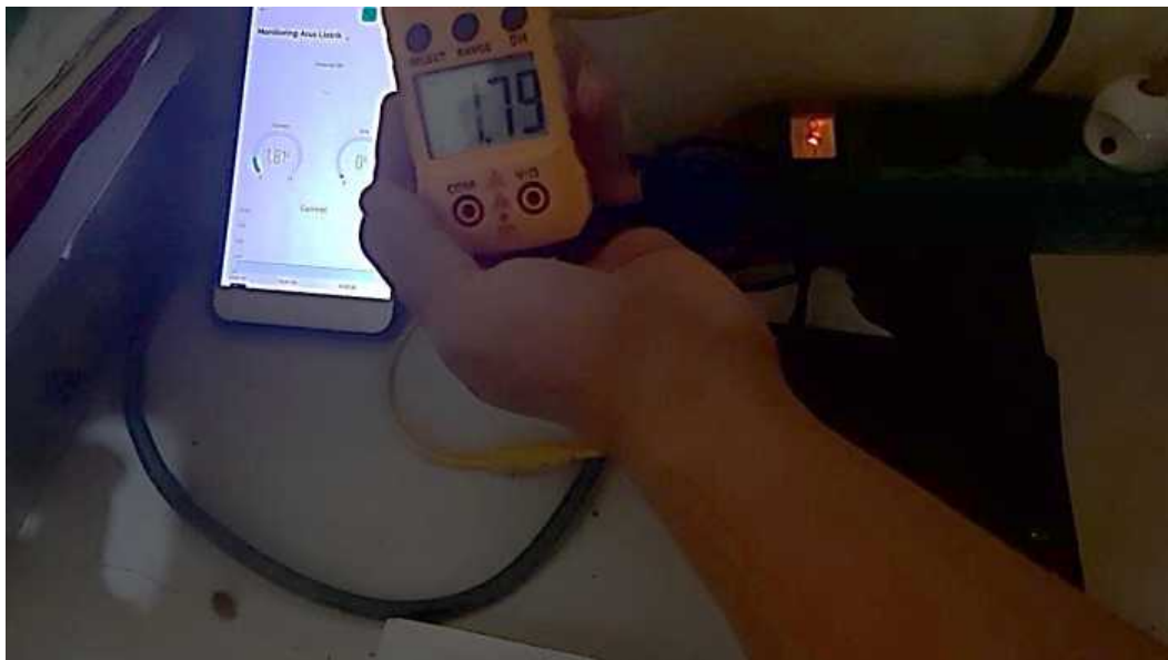
Lampiran 6 Pengujian sensor SCT-013 pada AC
