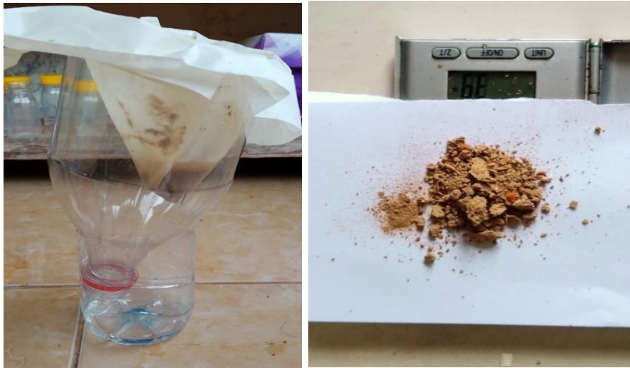
Penyaringan menggunakan kertas saring dan penimbangan substrat menggunakan timbangan digital
