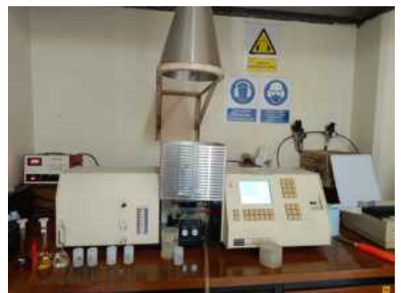
Proses injeksi sampel utk analisis kadar Nikel dengan menggunakan alat Atomic Absorption Spectrophotometer (AAS)
