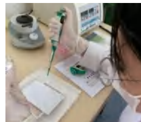
Penambahkan 10 \mu L antibodi anti-IL-6 pada well sampel
