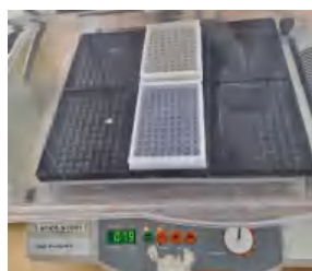
Plate diinkubasi selama 60 menit pada suhu 37°C.
