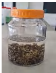
Sampel di rendam menggunakan methanol selama 24 jam
