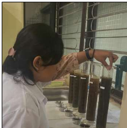
Pengujian sampel tekstur substrat menggunakan Hidrometer.
