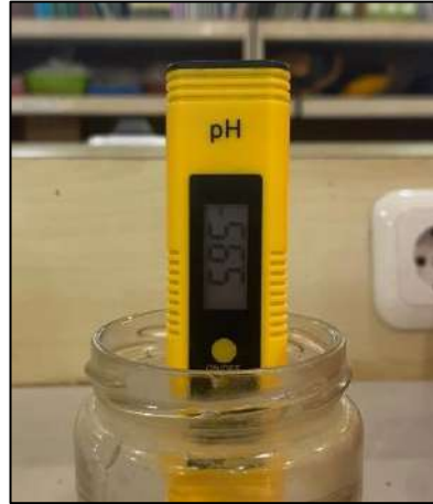
Pengukuran pH air menggunakan pH meter
