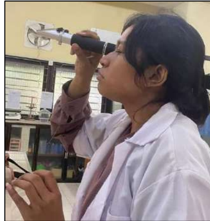
Pengukuran salinitas air menggunakan Hand-salino refractometer .
