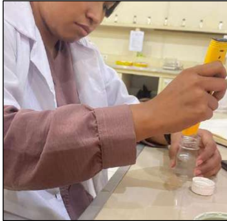
Pengukuran pH air menggunakan pH meter
