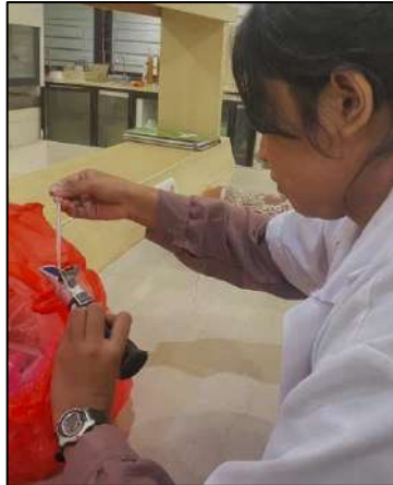
Pengukuran salinitas air menggunakan Hand-salino refractometer .
