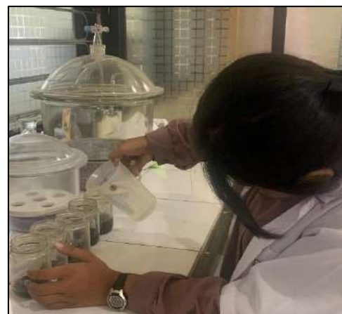
Pengujian sampel tekstur substrat menggunakan Hidrometer.
