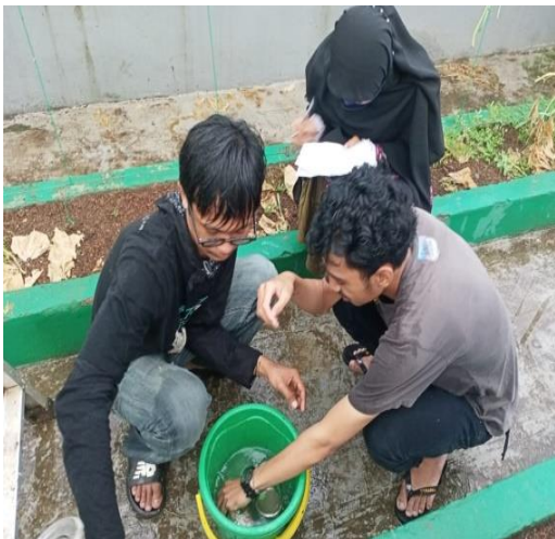
Gambar 4. Pengukuran debit sprinkler
