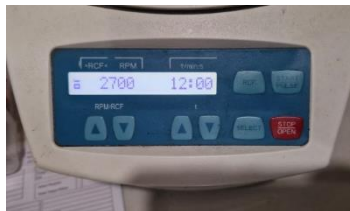
Gambar 18. Pengaturan kecepatan dan waktu sentrifugasi
