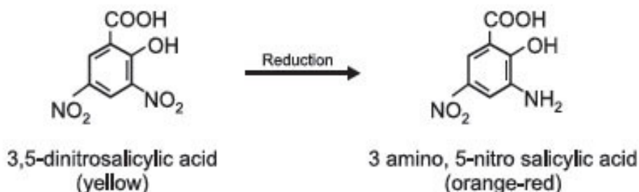
Gambar 1. Prinsip Pengujian Kadar Fruktosa Metode DNS
