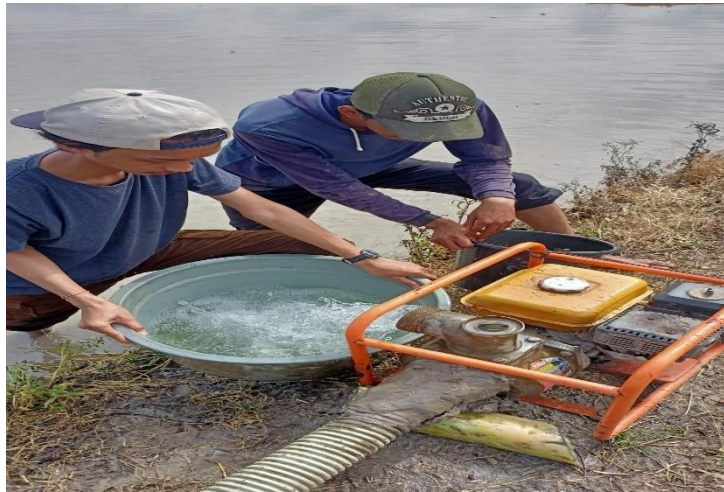
Gambar 9. Pengukuran debit air mesin BBM
