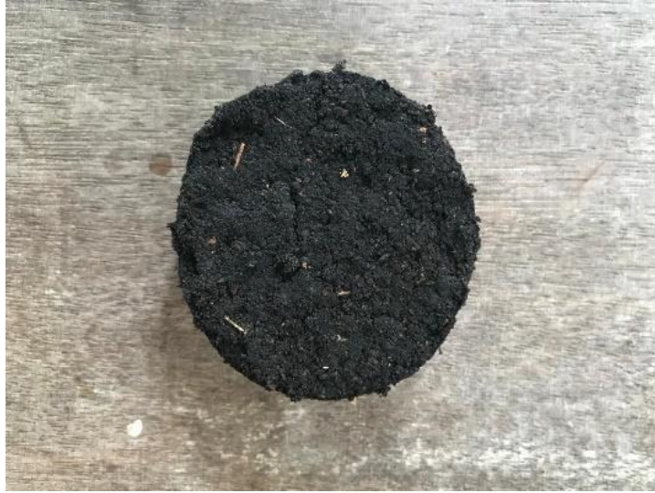
Gambar L4- 16. Briket dengan bahan ampas sagu setelah pretreatment NaOH 30%.
