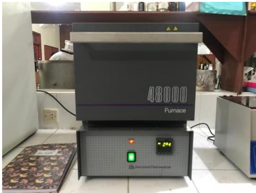
Gambar L4-7. Sampel dipanaskan dengan tanur selama kurang lebih 5 jam dengan suhu 650 °C.
