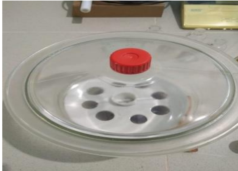
Gambar L4-8. Sampel kemudian dimasukkan ke dalam desikator.
