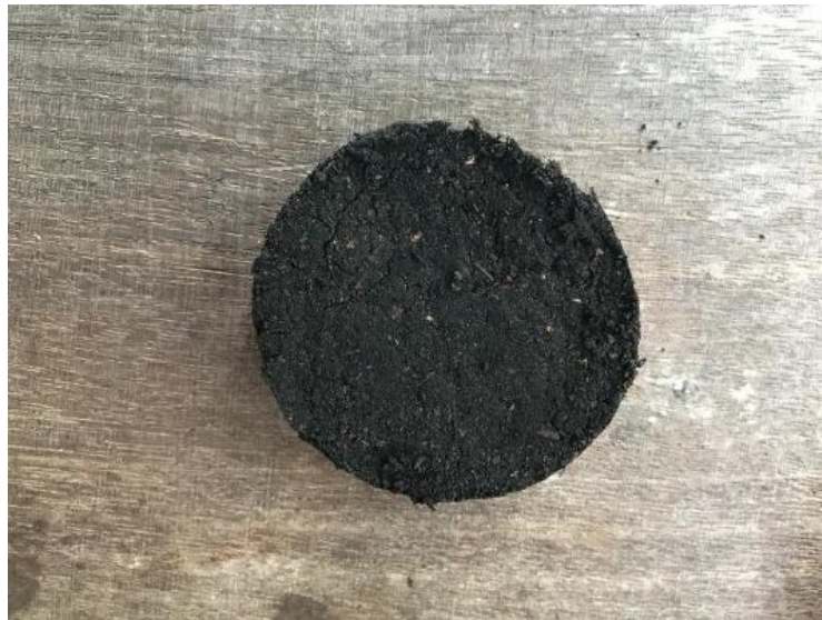
Gambar L4- 15. Briket dengan bahan ampas sagu Setelah pretreatment NaOH 10%.
