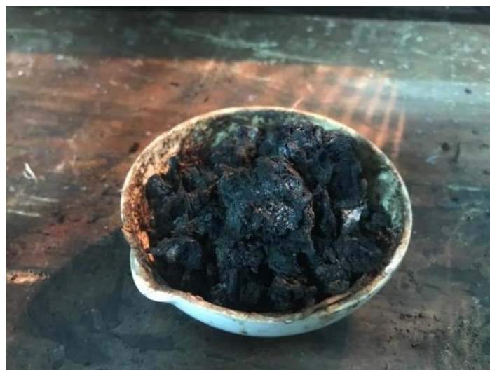
Gambar L4- 13. Biochar ampas sagu setelah pretreatment perendaman NaOH 30% dan microwave pyrolysis 540 watt.
