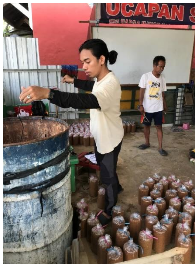
Gambar 31. Pemasangan Sensor Pada Alat Sterilisasi.
