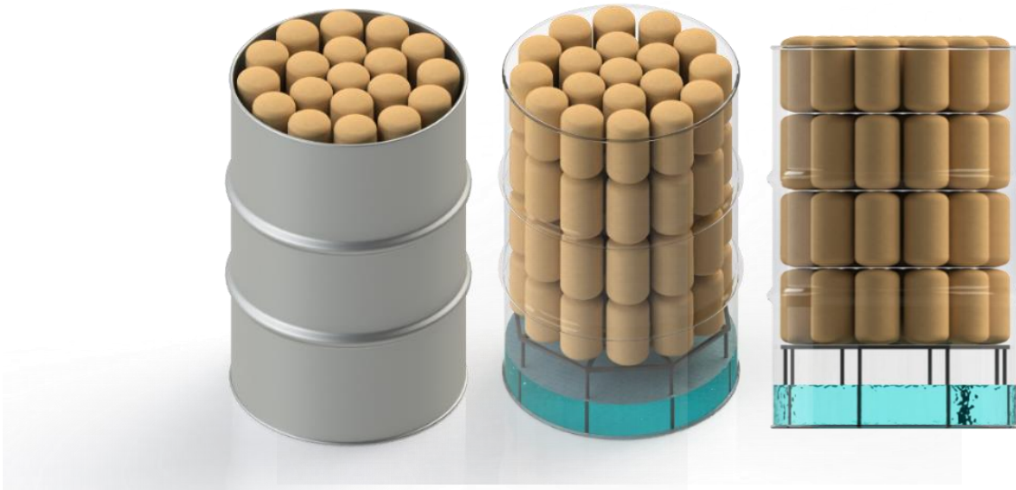
Gambar 24. Ilustrasi Steamer Drum dan Baglog .
