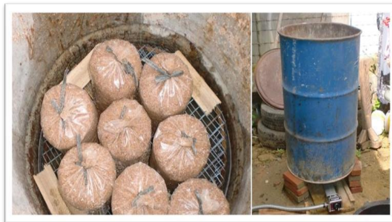
Gambar 1. Alat sterilisasi drum (Hermanto, 2017).
