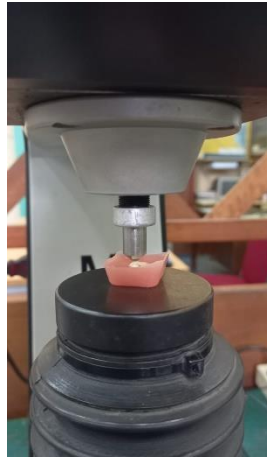
Uji Vickers Hardnes Tester pada salah satu sampel gigi
