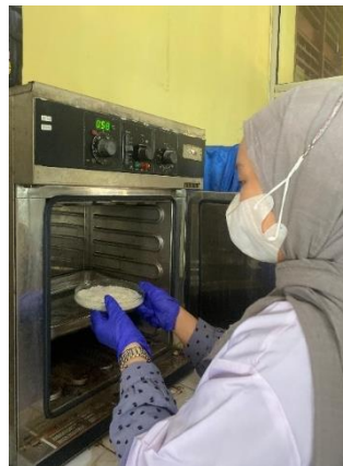
Sampel yang telah menjadi pasta dikerigkan dalam oven suhu 650°C
