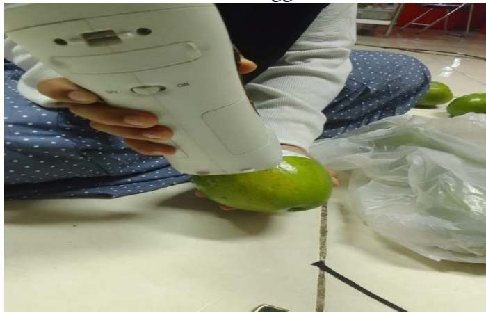
Gambar 12. Pengukuran warna alpukat menggunakan colorimeter
