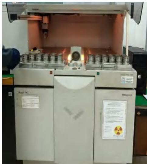
**Gambar 2.4** Alat *X-Ray Fluorescence* MagiX Fast (Dokumentasi Penulis)
