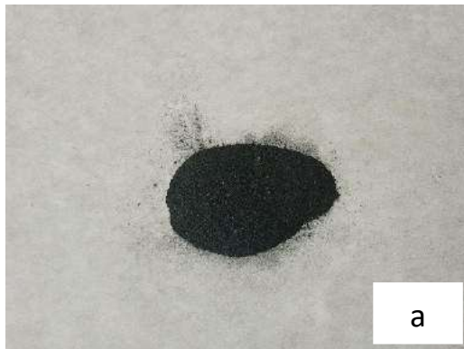
Hasil sintesis carbon nanotube (CNT) (a) Karbon aktif 100%; (b) Karbon aktif 97% + \text{CoSO}_4 3%
