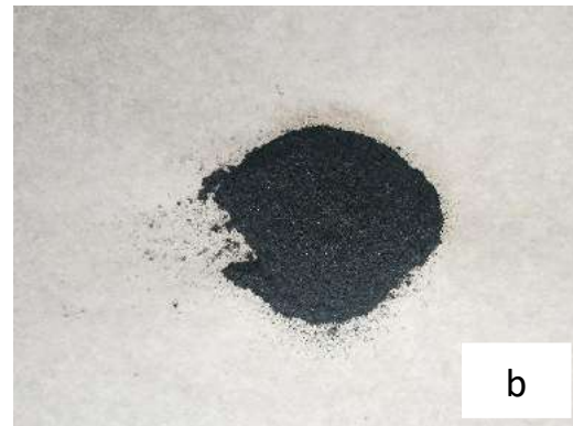
Hasil sintesis carbon nanotube (CNT) (a) Karbon aktif 100%; (b) Karbon aktif 97% + \text{CoSO}_4 3%
