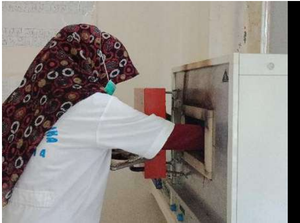
Proses karbonisasi dengan furnace
