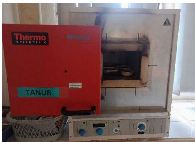
Pemanasan pada suhu 600^\circ\text{C}
