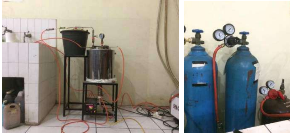
Seperangkat alat chemical vapour deposition (CVD)
