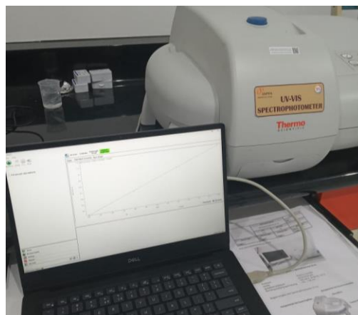
Gambar 21. Penentuan persentase removal fosfat menggunakan spektrofotometri UV-Vis
