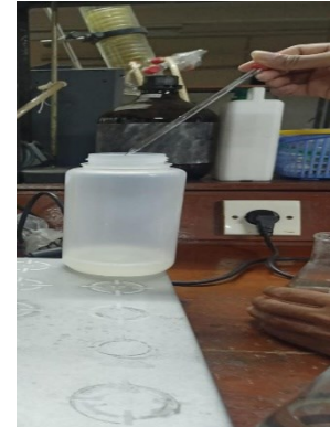
Pencampuran larutan natrium silika dan surfaktan
