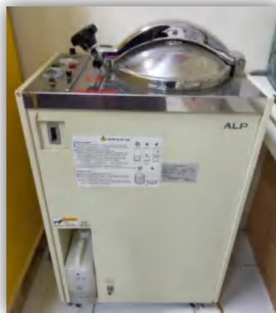
Proses sterilisasi substrat limbah alga menggunakan autoclave
