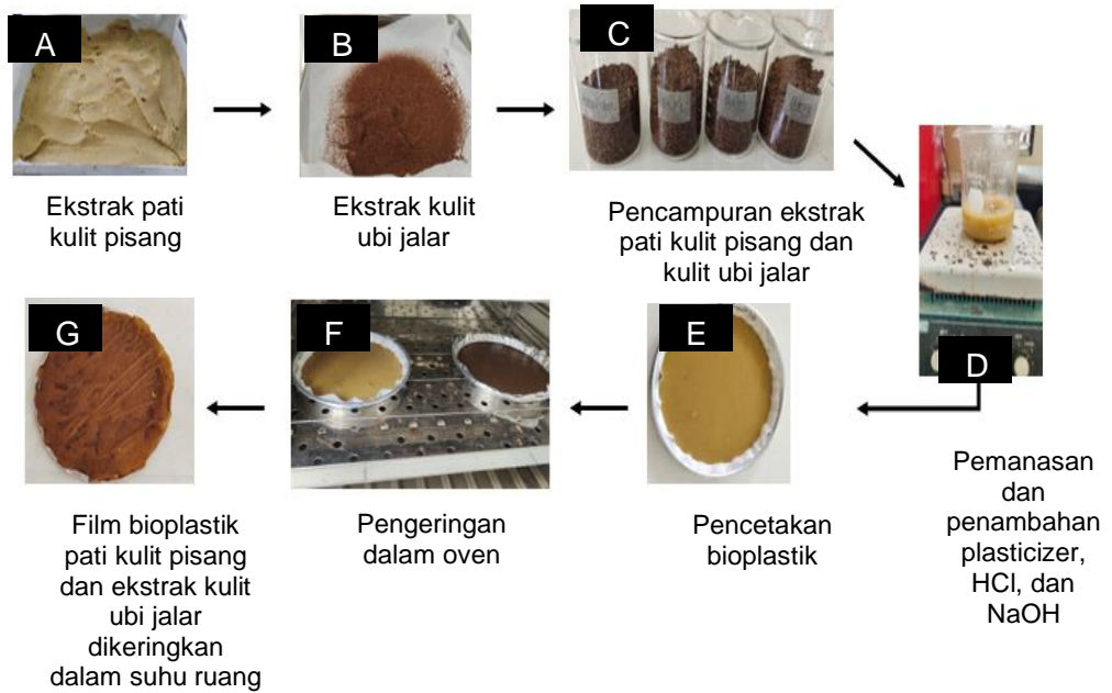
Gambar 13. Diagram skema proses pembuatan bioplastik.
