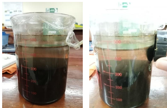
Gambar 3. Terbentuk Magnetit yang dapat Ditarik Magnet
