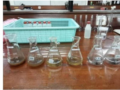
Gambar 7. Larutan dikontakkan dengan Adsorben dan shaker 200 rpm
