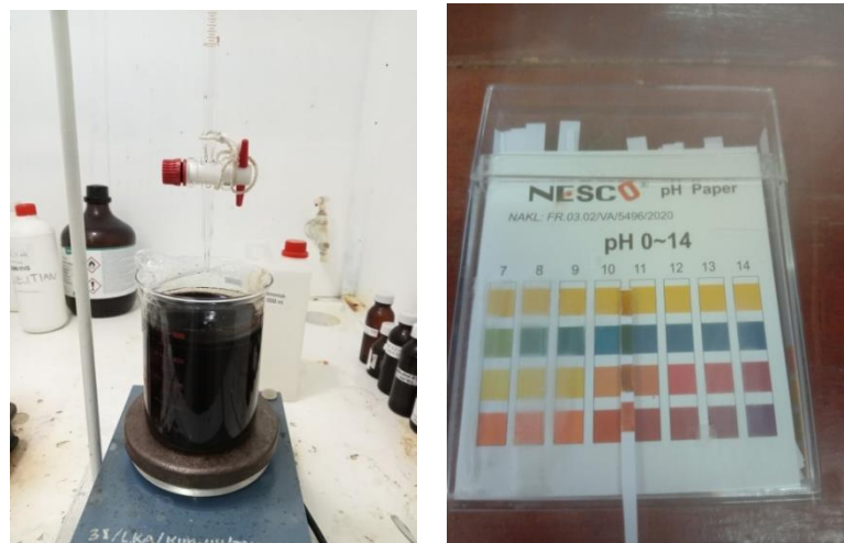
Gambar 2. Proses Penambahan \text{NH}_4\text{OH} 25% sampai Warna Hitam Pekat pH 11
