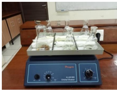
Gambar 7. Larutan dikontakkan dengan Adsorben dan shaker 200 rpm
