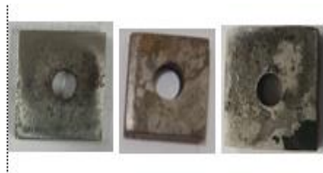
26. Hasil perendaman baja karbon tanpa inhibitor variasi suhu dalam \text{CH}_3\text{COOH} 25%
