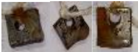
29. Hasil perendaman baja karbon dengan penambahan inhibitor variasi waktu suhu dalam media air laut
