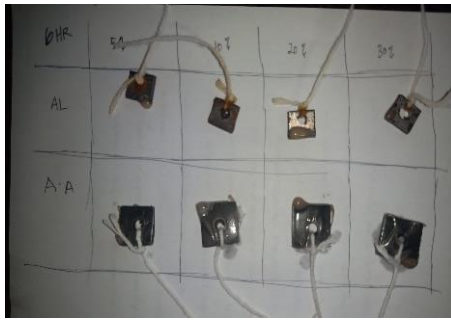
23. Hasil perendaman dengan inhibitor hari ke 6 dalam media air laut dan media \text{CH}_3\text{COOH} 25%
