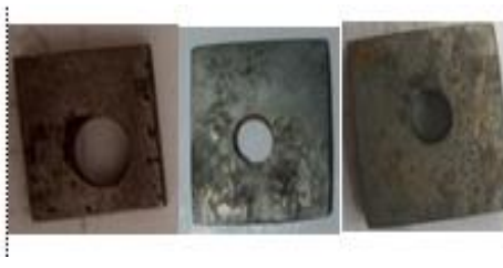
28. Hasil perendaman baja karbon sebagai kontrol dengan variasi suhu dalam media \text{CH}_3\text{COOH} 25%
