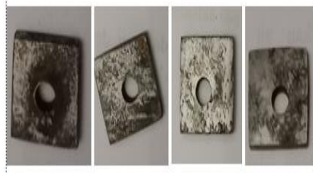
18. Hasil perendaman baja karbon tanpa inhibitor variasi waktu dalam \text{CH}_3\text{COOH} 25%
