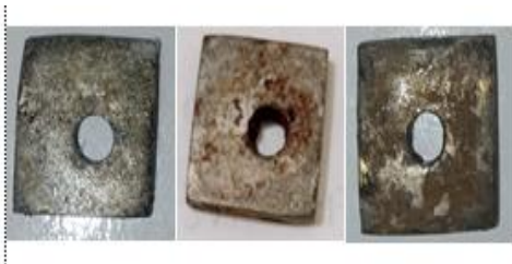
27. Hasil perendaman baja karbon sebagai kontrol dengan variasi suhu dalam media air laut
