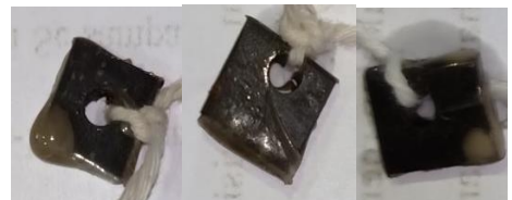
30. Hasil perendaman baja karbon dengan penambahan inhibitor variasi waktu suhu dalam media \text{CH}_3\text{COOH} 25%
