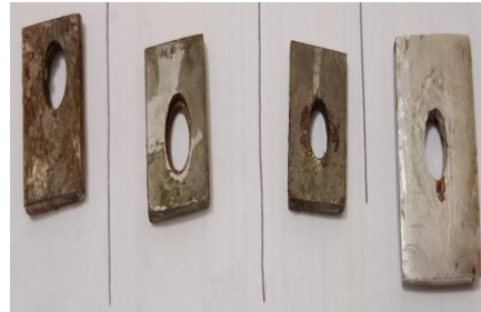
20. Hasil perendaman baja karbon sebagai kontrol dengan variasi waktu perendaman dalam media \text{CH}_3\text{COOH} 25%
