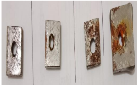
19. Hasil perendaman baja karbon sebagai kontrol dengan variasi waktu perendaman dalam media air laut
