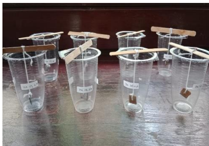
11. Baja yang telah dilapisi inhibitor
