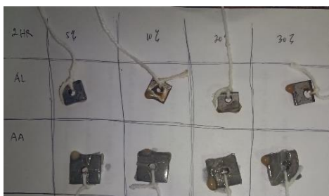
21. Hasil perendaman dengan inhibitor hari ke 2 dalam media air laut dan media \text{CH}_3\text{COOH} 25%
