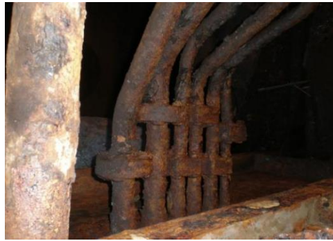
Gambar 4. Korosi seragam pada pipa ballast (Utomo, 2009)
