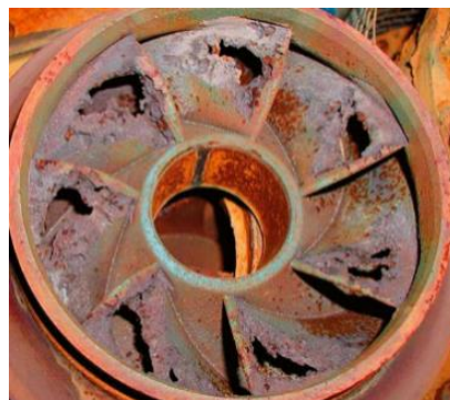
Gambar 11. Korosi kavitasi (Purnomo, 2015)
