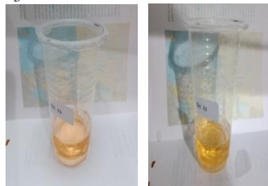
14. Proses perendaman baja dengan inhibitor media \text{CH}_3\text{COOH} 25%
