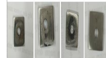
36. Hasil perendaman baja karbon dengan inhibitor konsentrasi 30% dalam media \text{CH}_3\text{COOH} 25%
