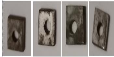
30. Hasil perendaman baja karbon dengan inhibitor konsentrasi 5% dalam media \text{CH}_3\text{COOH} 25%
