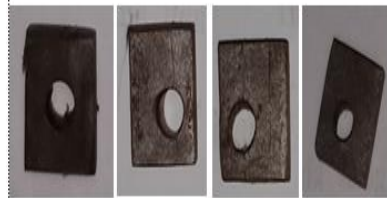
30. Hasil perendaman baja karbon dengan inhibitor konsentrasi 5% dalam media \text{CH}_3\text{COOH} 25%
