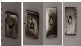
35. Hasil perendaman baja karbon dengan inhibitor konsentrasi 30% dalam media air laut
