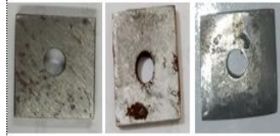
42. Hasil perendaman baja karbon dengan penambahan inhibitor variasi waktu suhu dalam media \text{CH}_3\text{COOH} 25%
