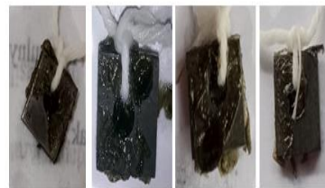
16. Proses perendaman baja sebagai kontrol media \text{CH}_3\text{COOH} 25%
