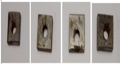
29. Hasil perendaman baja karbon dengan inhibitor konsentrasi 5% dalam media air laut
