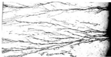
Gambar 9. Korosi tegangan (Utomo, 2009)
