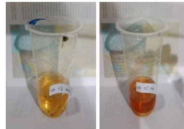
14. Proses perendaman baja dengan inhibitor media \text{CH}_3\text{COOH} 25%
