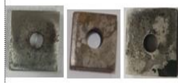
40. Hasil perendaman baja karbon tanpa inhibitor variasi suhu dalam \text{CH}_3\text{COOH} 25%
