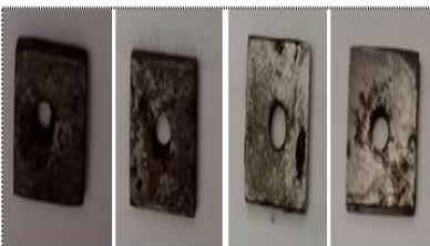
27. Hasil perendaman baja karbon tanpa inhibitor variasi waktu dalam media air laut
