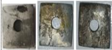
39. Hasil perendaman baja karbon tanpa inhibitor variasi suhu dalam media air laut
