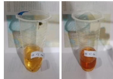
14. Proses perendaman baja dengan inhibitor media \text{CH}_3\text{COOH} 25%
