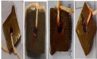
25. Pengangkatan baja karbon dengan konsentrasi 30% media air laut
