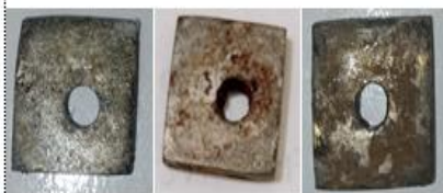
43. Hasil perendaman baja karbon sebagai kontrol dengan variasi suhu dalam media air laut
