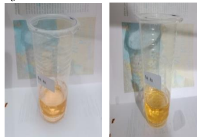
14. Proses perendaman baja dengan inhibitor media \text{CH}_3\text{COOH} 25%
