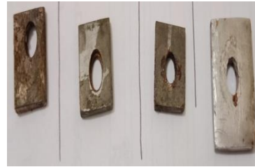
38. Hasil perendaman baja karbon sebagai kontrol dengan variasi waktu perendaman dalam media \text{CH}_3\text{COOH} 25%
