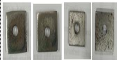
33. Hasil perendaman baja karbon dengan inhibitor konsentrasi 20% dalam media air laut
