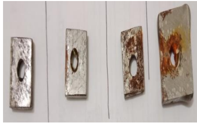
37. Hasil perendaman baja karbon sebagai kontrol dengan variasi waktu perendaman dalam media air laut
