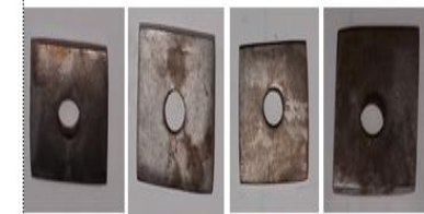
34. Hasil perendaman baja karbon dengan inhibitor konsentrasi 20% dalam media \text{CH}_3\text{COOH} 25%
