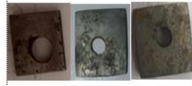
44. Hasil perendaman baja karbon sebagai kontrol dengan variasi suhu dalam media \text{CH}_3\text{COOH} 25%
