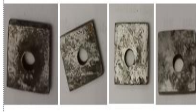
28. Hasil perendaman baja karbon tanpa inhibitor variasi waktu dalam \text{CH}_3\text{COOH} 25%
