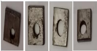
31. Hasil perendaman baja karbon dengan inhibitor konsentrasi 10% dalam media air laut
