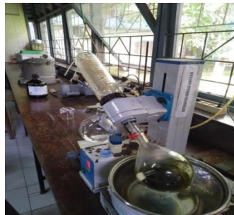
5. Filtrat sampel dievaporasi
