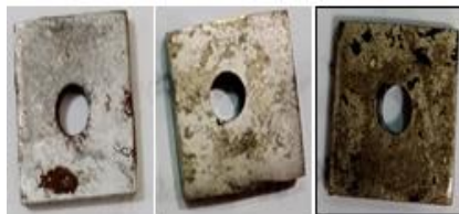
41. Hasil perendaman baja karbon dengan penambahan inhibitor variasi waktu suhu dalam media air laut
