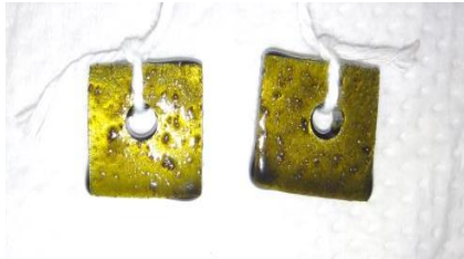
11. Baja yang telah dilapisi inhibitor
