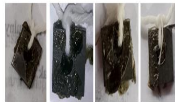
16. Proses perendaman baja sebagai kontrol media \text{CH}_3\text{COOH} 25%
