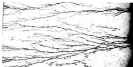
Gambar 9. Korosi tegangan (Utomo, 2009)
