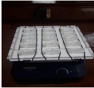
Pengocokan dengan alat shaker untuk pengaruh waktu dan konsentrasi terhadap adsorpsi DEHP
