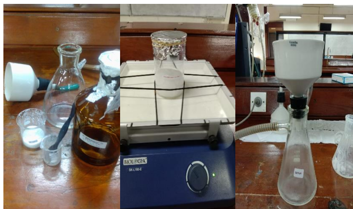
Proses pencucian polimer dengan aseton, metanol, dan akuades agar bersih dari pengotor
