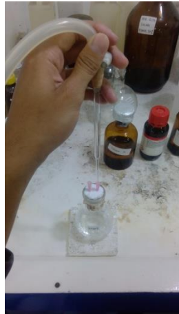
Pengaliran gas nitrogen untuk menghilangkan gas oksigen
