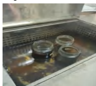
Gambar 7. Menguapkan pelarut dan kadar air pada ekstrak menggunakan waterbath
