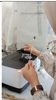
Proses kalibrasi dan peletakan sampel plastik pada sensor
