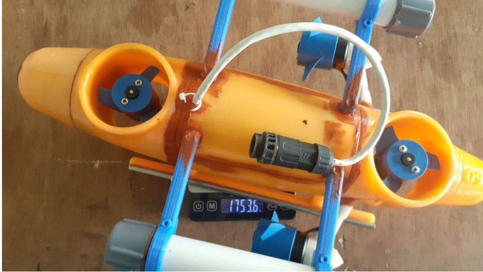
a. Mengukur berat keseluruhan underwater robot
