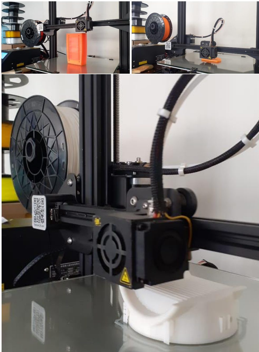
g. Proses cetak part body menggunakan printer 3D
