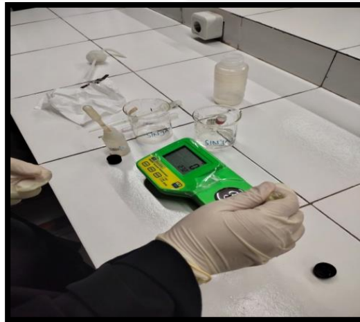
Pengukuran pH, suhu dan salinitas
