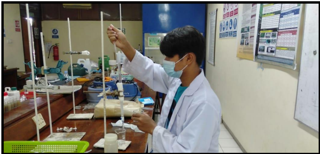
Proses kolom kromatografi (pemisahan)
