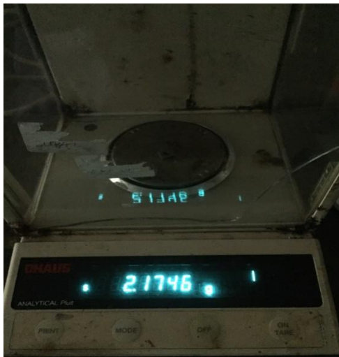
19. Penimbangan sebelum korosi
