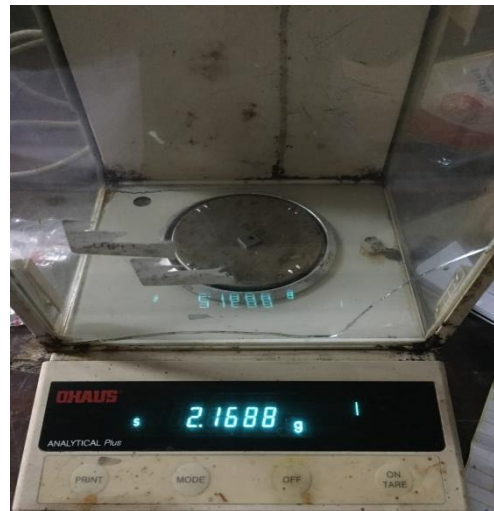
20. Penimbangan setelah korosi
