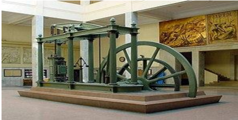
Penampakan mesin uap Watt, yang menjadi pijakan untuk revolusi industri pertama.
