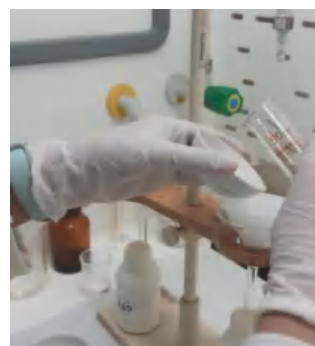
Sampel disaring diambil filtratnya untuk analisis Fe dan Zn
