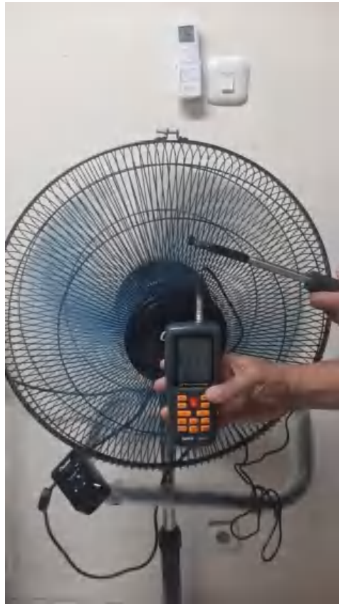
Lampiran 7 Pengujian kecepatan udara kipas
