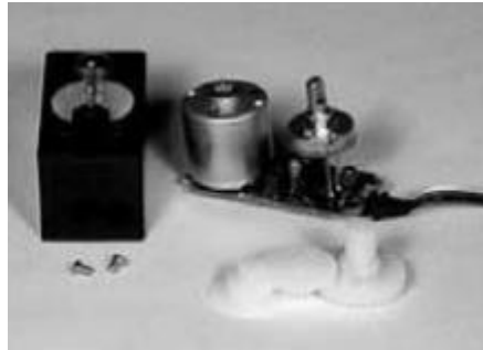
Gambar 8 Bagian-bagian motor servo Sumber: Nur Rifqah Muchlis, 2023 (2)
