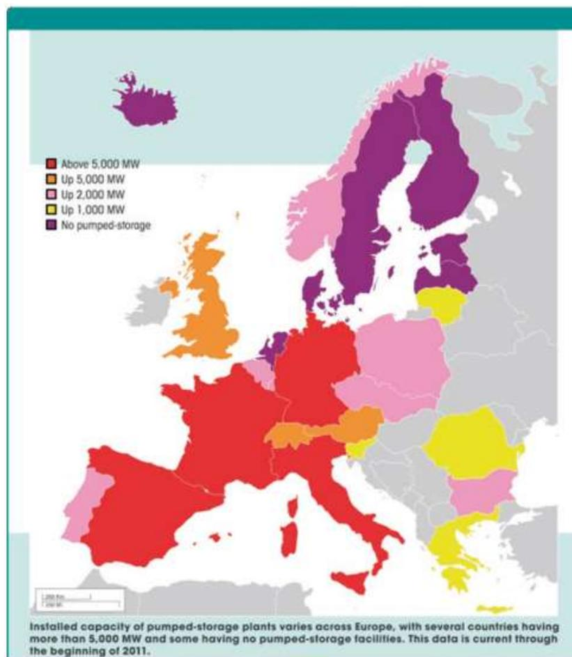
**Gambar 4 Kapasitas Penyimpanan Energi Hidro di Eropa**
