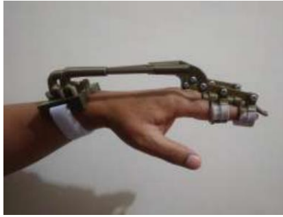
Gambar 3. Exoskeleton dengan kontrol otot pengguna (Mahardhika, P.S. 2018)
