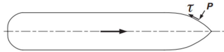
Gambar 1 Ilustrasi gaya geser tangensial \tau dan gaya tekan P yang terjadi pada permukaan lambung kapal.
